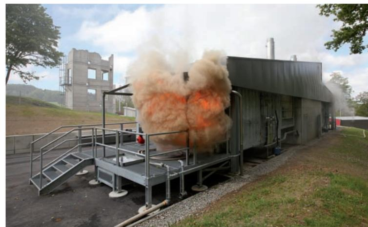
produire des feux confinés spécifiques. L'embrasement généralisé éclair est simulé dans le caisson «flashover», l'explosion de fumée dans le caisson «backdraft».
